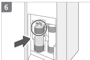
新しいフィルターの上部をつかみ、本体のフィルター接続部に平行に押し込んで取り付けます。
