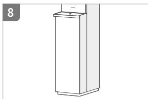
前面カバーを上からスライドさせて閉じた後、受け皿を再度取り付けます。
