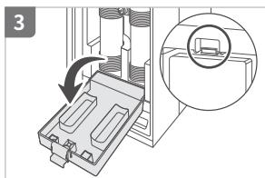
フィルターカバーのレバーを押して、カバーを開けます。
